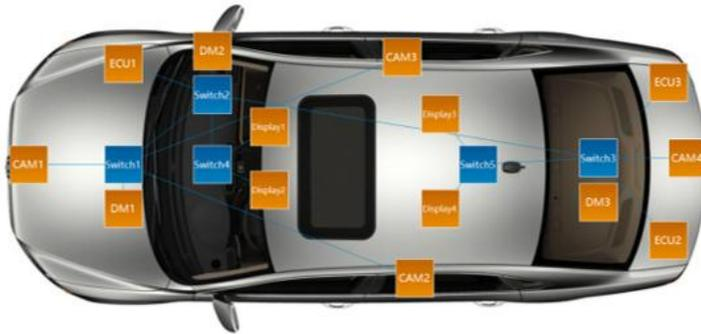
图 4 RTaW-Pegase 构建的汽车网络架构
